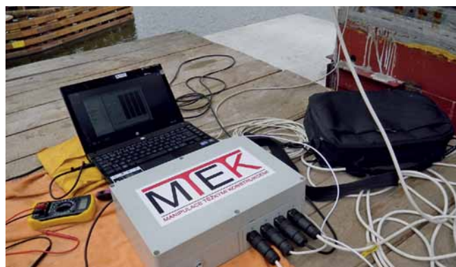
Čtyřkanálová měřicí ústředna při měření dynamických jevů během výsuvu mostu
